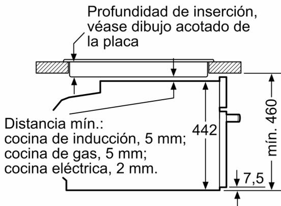
Si se instala el aparato compacto debajo de una placa, se debe respetar el siguiente grosor de encimera (incl., dado el caso, la estructura de soporte).
